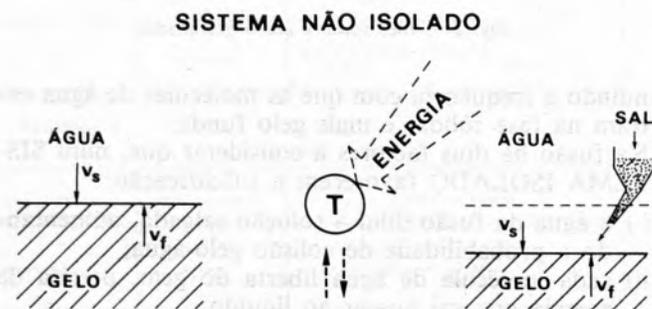
Fig. 4 — Sistema não Isolado: O ambiente repõe a energia consumida, mantendo-se a temperatura constante
