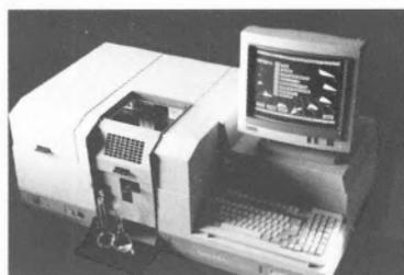
Também da Varian, o SpectrAA - 250 Plus é um económico sistema de absorção atómica que proporciona as mais diversas possibilidades. Disponde de software central de controlo e de uma automatização completa, garante que as melhores condições de trabalho sejam rapidamente atingidas para qualquer tipo de análise: chama, forno ou hidretos.
