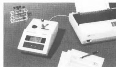
Devido à programação inserida nos aparelhos, o manuseamento é muito simples: basta introduzir a amostra no porta cuvettes, seleccionar o método e o resultado, em mg/l, aparece de imediato no visor.
