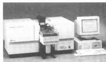
com reconhecimento da posição de injeção dentro do tubo de grafite, cálculo automático da diluição de amostras fora da curva calibração, etc.
