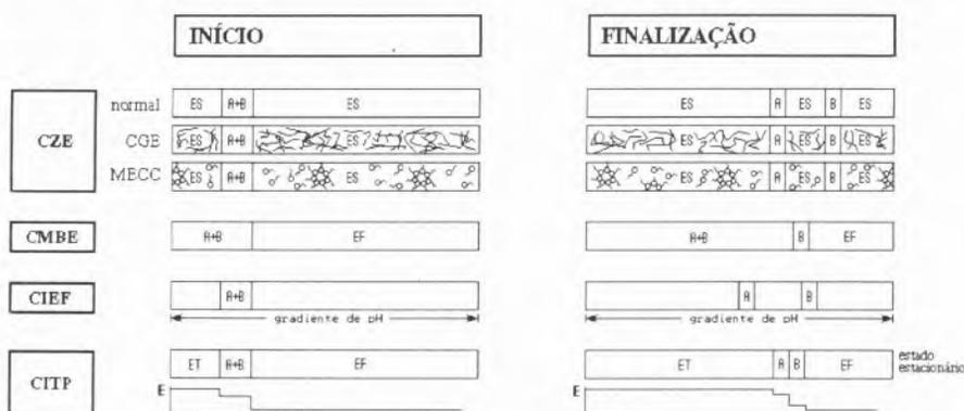
Figura 4: Revisão esquemática dos modos de Electroforese Capilar. ES- electrólito suporte; EF- electrólito frontal; ET- electrólito terminal; A e B são os componentes da amostra.
