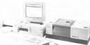
**A6 - Novo Espectrómetro FT-IR Vector 22 "BRUKER"**
