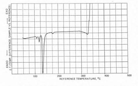
Fig. 1 - Análisis térmico diferencial de una mezcla nitrato potásico/azufre/aluminio. Se distinguen las endotermas del azufre a 105 y 119°C, y una transición de fase del nitrato potásico hacia 130°C. Cerca del punto de fusión del KNO3 (334°C) se observa un gran exoterma, resultado de una deflagración. Tomado de Conkling (4).
