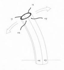
Fig. 5 - Sistema de varrimento piezoeléctrico de tubo sgmentado
