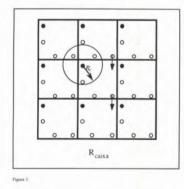
Fig. 3 - Representação esquemática do uso de condições periódicas de fronteira a duas dimensões. O sistema central tem oito cópias dele próprio em seu redor. O átomo situado no centro da circunferência não "vê" as suas cópias nos sistemas circundantes, devido ao uso do raio de interacção máxima R.
