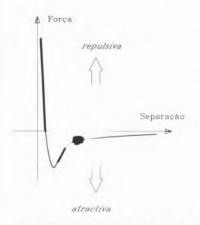
Fig. 3 - Força de Van der Waals versus separação ponta-amostra. A linha carregada indica as duas zonas de operação.
