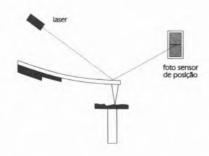
Fig. 2 - Detecção do encurvamento da viga
