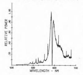
Fig. 2 - Espectro de emisión de una bengala amarilla. La principal especie emisora es el sodio atómico, centrada hacia 589 nm. Se observa. además, una banda ancha y continua de emisión de incandescencia ("cuerpo negro"). Tomado de Webster (5).
