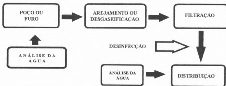
Fig. 2 - Remoção de ferro e manganês
