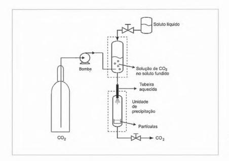
**figura 2** Esquema de uma instalação PGSS para produção de micropartículas usando CO<sub>2</sub> supercrítico.
