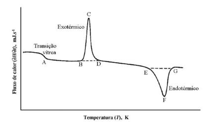
**Figura 2** Curva genérica de DSC para um composto polimérico.  $\partial H/\partial t$  corresponde ao fluxo de energia calorífica (adaptado de [3]).
