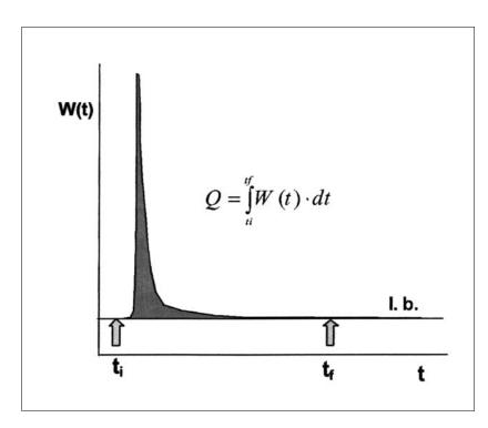
**Figura 6** Pico característico de resposta a uma injecção de um reagente (ligando) sobre outro que se encontra na célula reaccional (biopolímero). A energia calorífica gerada na reacção é obtida por integração da função W(t) sobre a linha de base, l.b. (adaptado de [6]).
