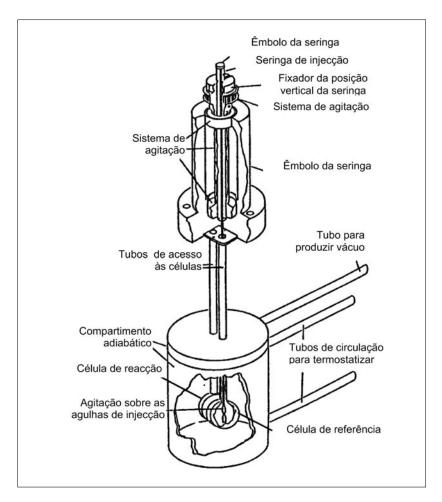
**Figura 5** Esquema das células calorimétricas, cilindro adiabático e do conjunto injector/agitador de um calorímetro de titulação baseado no princípio de medida por compensação do efeito térmico num compartimento adiabático (adaptado de [6]).
