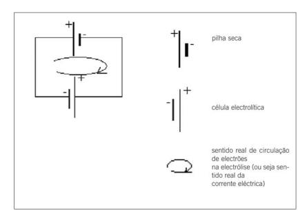
**Figura 2** Esquema do circuito eléctrico de demonstração para a electrólise.
