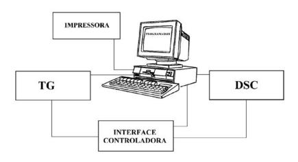
Figura 1 Representação esquemática de instrumentação TG-DSC.
