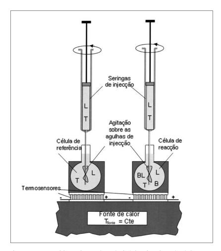
**Figura 4** Esquema geral de um calorímetro isotérmico de titulação baseado no princípio da condução de energia sob a forma de energia calorífica através de sensores de baixa impedância térmica. L, T e B representam respectivamente moléculas de ligando, de tampão e de biopolímero (adaptado de [6]).
