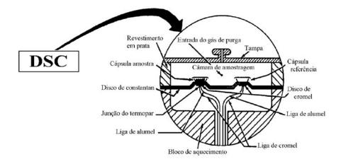
Figura 3 Representação esquemática da secção transversal de um equipamento de DSC da DuPont (adaptado de [3]).
