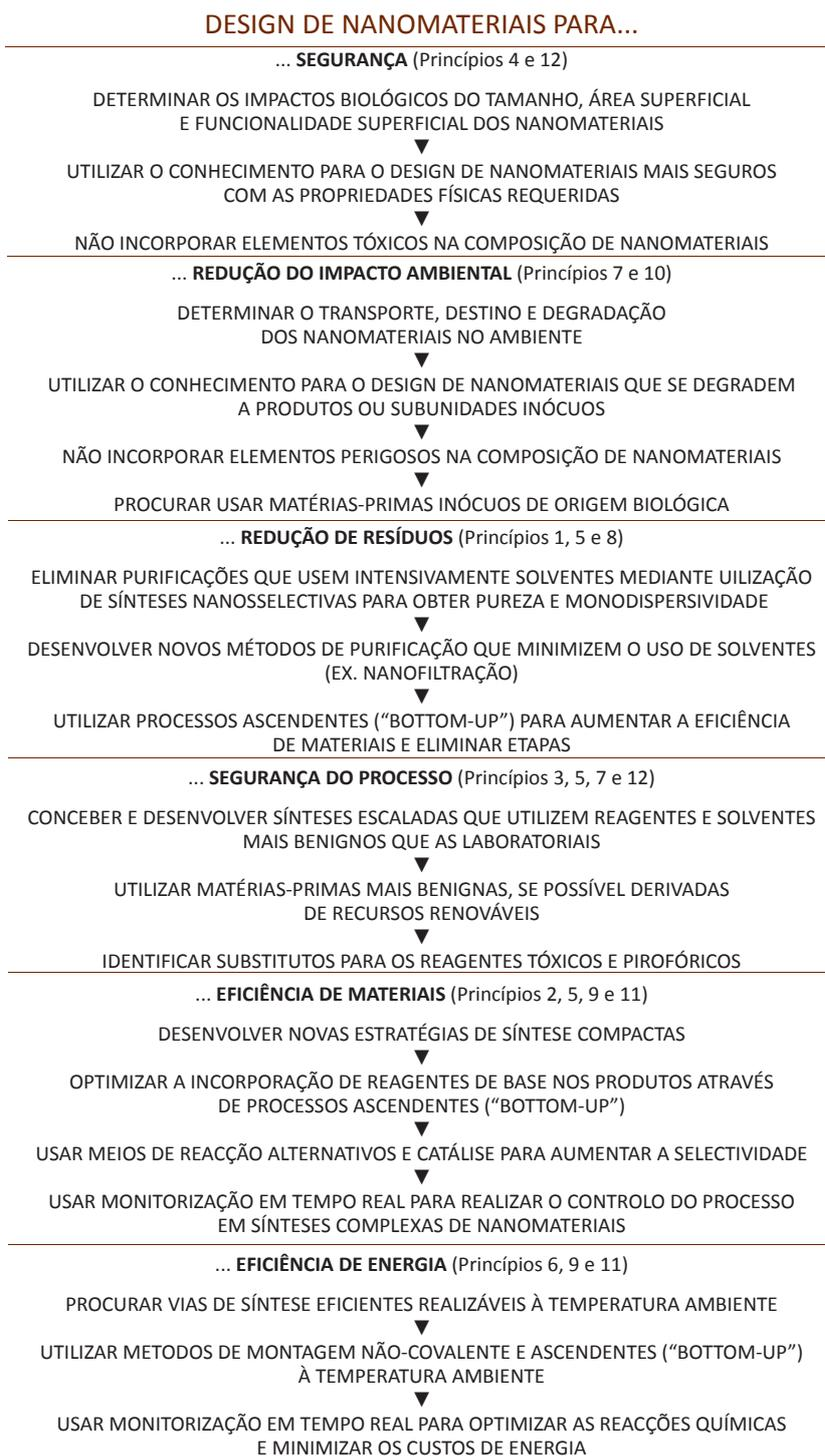
**Figura 2** Uso dos Princípios da QV na concepção e fabrico de novos nanomateriais segundo a postura do “Design para...”
